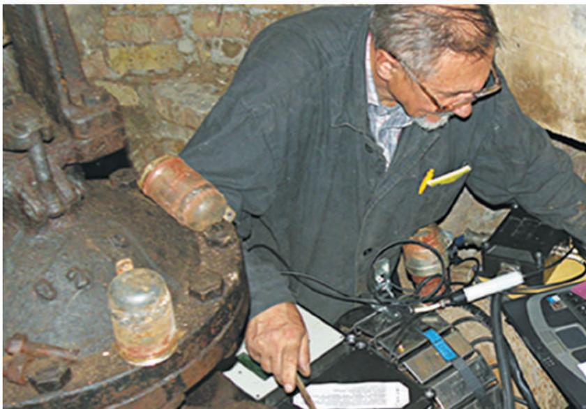
Пример антенны на труднодоступных технологических трубопроводах с  $T_{\text{поверхности}}$  до  $+800^{\circ}\text{C}$ , диаметром до 330 мм и свободные от транспортируемого продукта. Приборы работают на частотах 16, 36кГц, а диаметры контролируемых труб от 54 до 330 мм. Площадь мин. выявляемого коррозионного поражения 5...10% от площади поперечного сечения трубы.
