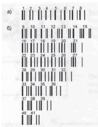
Рис. 7. Формирование штрих-кода за счет удаления одного (а) или двух (б) бандажей (тонкая линия) от монтажного шва (жирная линия)
