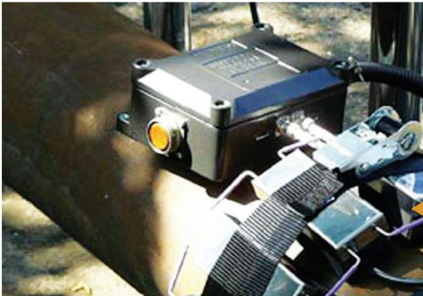
На поверхности технологического трубопровода, устанавливается кольцевая НЧ-антенна, состоящая из пьезопреобразователей. Кольцо антенны не перемещается вдоль трубы в процессе контроля. Антенна посылает направленные УЗ волны крутильной моды на расстояние до 150 м. Информация об отраженных сигналах выводится на экран ноутбука в виде развертки А-scan.
