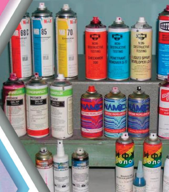
Для выполнения КК создан передвижной стенд, оборудованный вытяжкой и другими средствами для эффективного контроля. Стенд изготавливается по индивидуальным заказам ЦЗЛ и экспертно-технических организаций. КК может осуществляться цветоконрастным или люминесцентным методами с использованием дефектоскопических материалов ведущих мировых производителей
