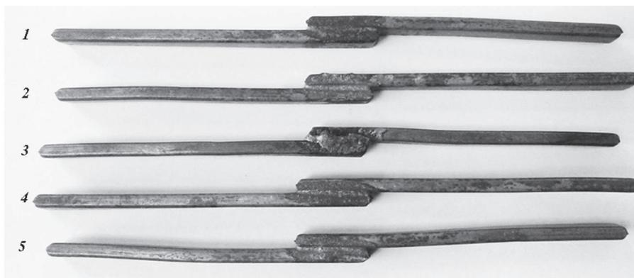
*Рис. 1 Общий вид паяных соединений статорных обмоток электродвигателя.*
