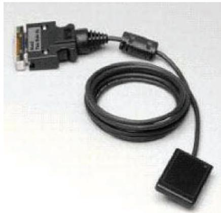
*Рис. 1. Внешний вид твердотельного плоскопанельного детектора S10811-11 ф. Hamamatsu с размером рабочего поля  $34 \times 24$  мм и площадью  $8,16 \text{ см}^2$  на 70 кВ*
