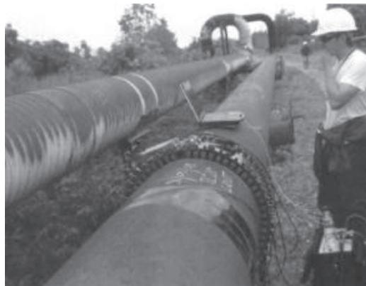
Рис. 3. Низкочастотная ультразвуковая диагностика
