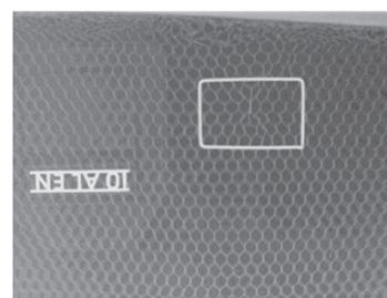
Рис. 4. Цифровое изображение фрагмента сотовой конструкции закрылка крыла самолета с локализацией дефектного участка для подробного исследования с помощью детектора S10811-11
