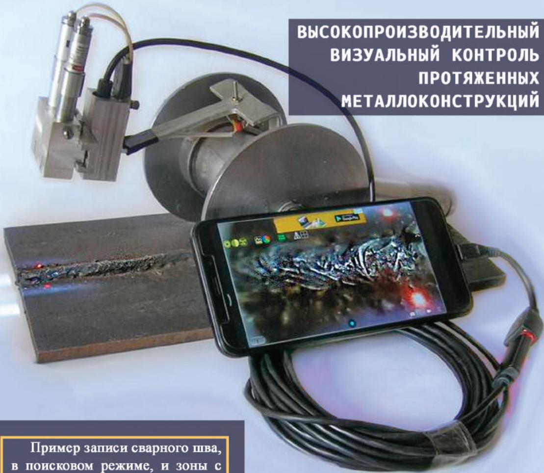
Пример записи сварного шва, в поисковом режиме, и зоны с предполагаемыми дефектами, в оценочном режиме. Полученные цифровые изображения сохраняются и в дальнейшем используются как документ.
